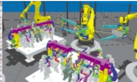
Simulation du fonctionnement des lignes de production et de montage de l'Opel Vectra
