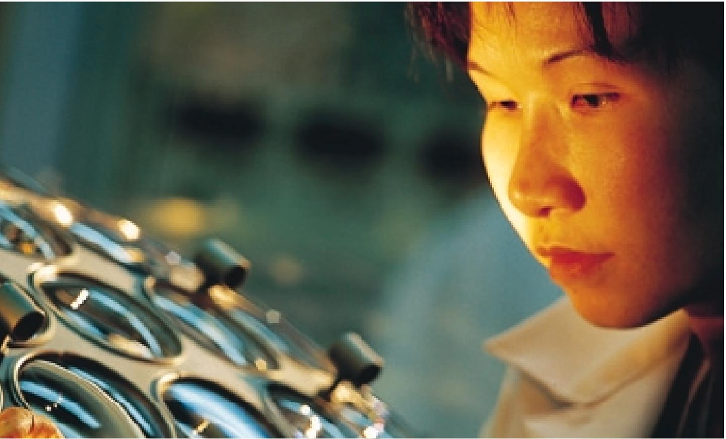
10 couches de traitement sont appliquées sur la face avant des verres Airwear Crizal Transitions.
