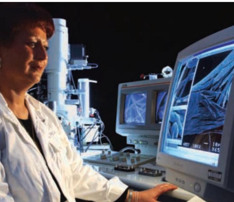
• Grâce à leur puissance de grossissement (x 10 000), ces microscopes électroniques permettent d'explorer et de comprendre la structure intime du cheveu et de la peau.
