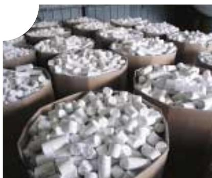
France - Plâtre - Recyclage de polystyrène expansé
