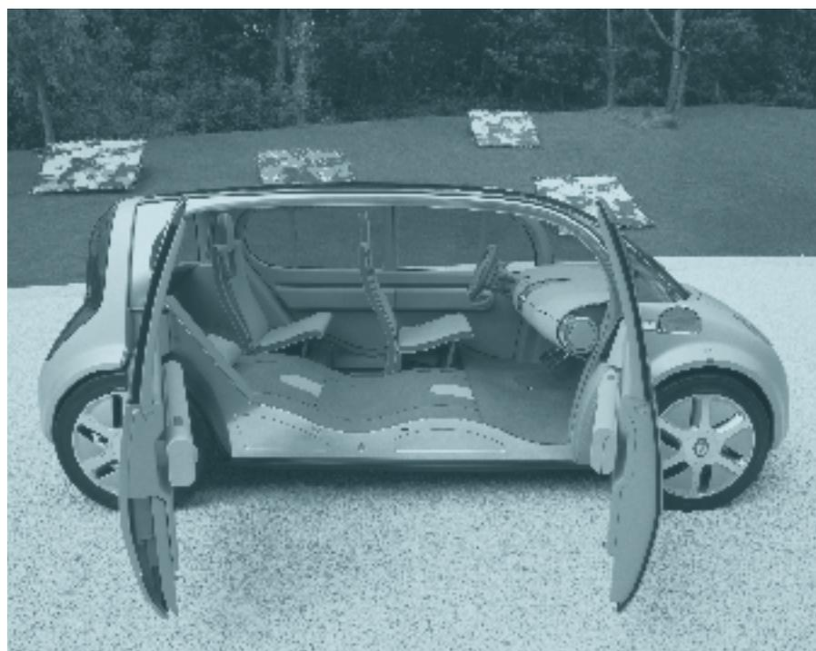
Les « sièges ingénieux » d'Ellypse peuvent se loger dans le plancher, passant ainsi d'une position « route » à une position « repos ».
