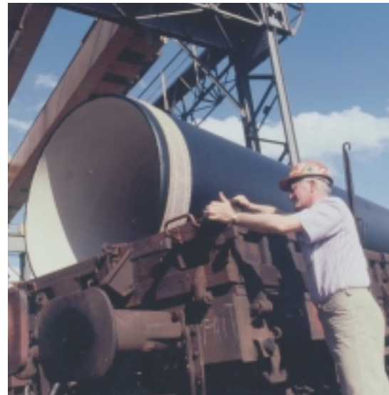
Vérification du calage lors du chargement de tuyaux grand diamètre.
